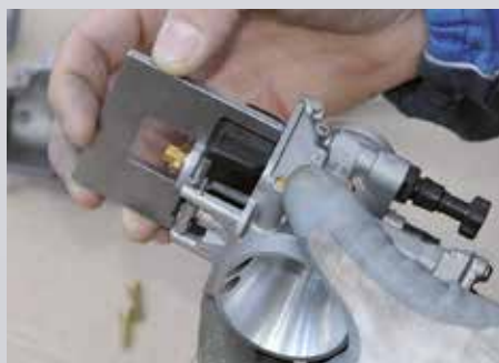
Float level check - Controllo livello galleggiante
