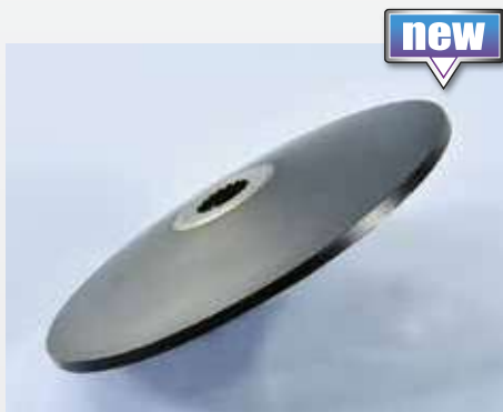
244.0127 Piaggio Zip fixed ceramized halfpulley 12,5° Semipuleggia fissa ceramicata 12,5°
