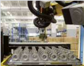
FLOAT WITH ULTRASONIC WELDING SALDATURA GALLEGGIANTE AD ULTRASUONI
