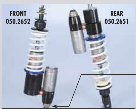
050.2650 Paoli shock absorber Piaggio Zip SP Coppia ammortizzatori Paoli Piaggio Zip SP
