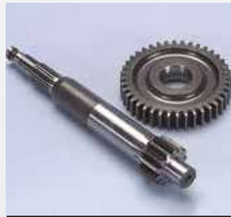
202.1378 Piaggio Z=13/40 Primary ratio-Primario
