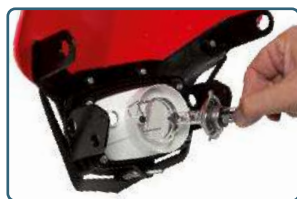
1 Retirer la lampe halogène
