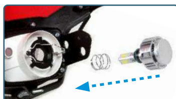
3 Insérer le ressort et la lampe led
